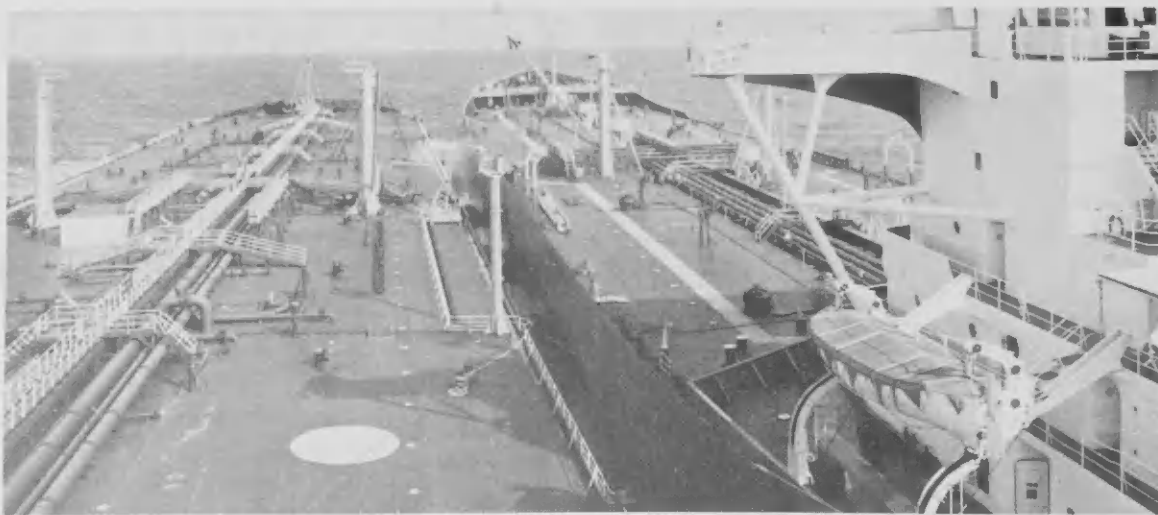
Mientras cu e MST ta ancla ■ ■ ■ ULCC/VLCC, preparacion ta wordo haci pa conecta e hose-nan pa traslado di crudo.
